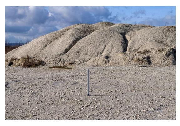
Dimensionen und Perspektiven im Griff: Der ins Bild gestellte Maßstab ist exakt 50 Zentimeter lang und vermittelt nicht nur die korrekten Dimensionen in diesem Bild, sondern auch die Richtung des einfallenden Lichts.
